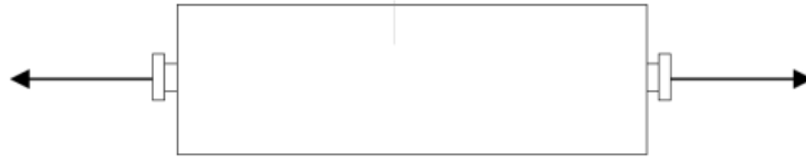
รูปที่ 2-3 รูปแบบแรงดึงตามแนวยาวที่กระทำต่อโครงสร้างรถไฟตามมาตรฐาน EN 12663
