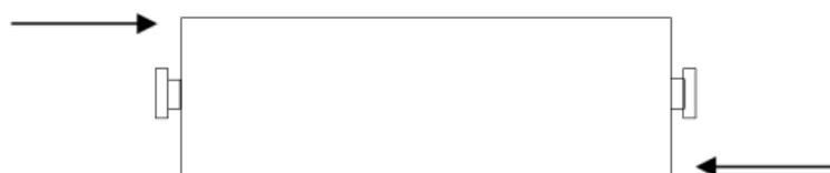
รูปที่ 2-2 รูปแบบแรงอัดตามแนวยาวทแยงมุมที่กระทำต่อโครงสร้างรถไฟตามมาตรฐาน EN 12663
