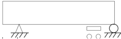
รูปที่ 2-4 รูปแบบการยกตัวรถที่ปลายหนึ่งด้านที่กระทำต่อโครงสร้างรถไฟตามมาตรฐาน EN 12663
