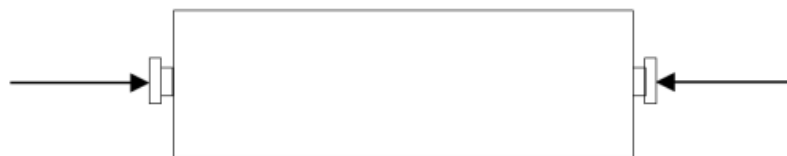
รูปที่ 2-1 รูปแบบแรงอัดตามแนวยาวที่กระทำต่อโครงสร้างรถไฟตามมาตรฐาน EN 12663
