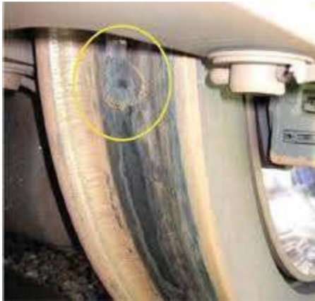
ภาพที่ 30 : ข่าย) ความเสียหายแบบจุดบนผิวล้อ (Wheel flat) ขว) การเกิดการกระแทกเนื่องจากความไม่กลมของล้อ
