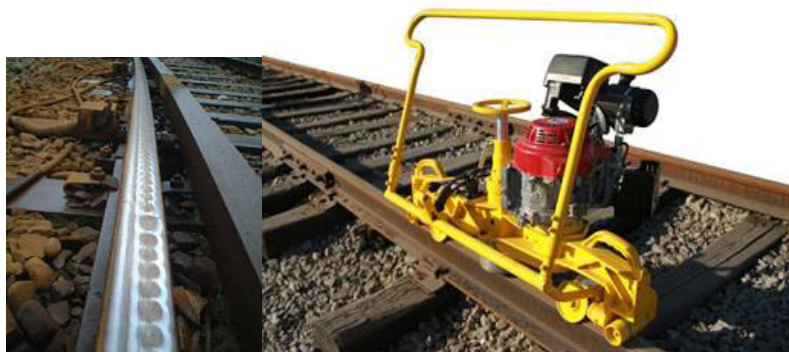
ภาพที่ 29 ซ้าย) ความเสียหายแบบคลื่นสั้นบนผิวราง ขวา) ตัวอย่างเครื่องมือในการเจียรราง
