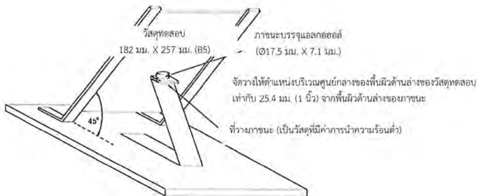
รูปที่ 13 ทดสอบการติดไฟสำหรับวัสดุที่ใช้ในรถขนส่งทางราง วิธีการที่ 1
