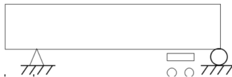
รูปที่ 8 รูปแบบการยกตัวรถที่ปลายหนึ่งด้านที่กระทำต่อโครงสร้างรถไฟตามมาตรฐาน EN 12663
