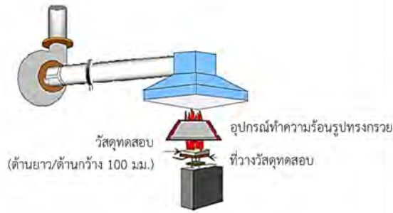
รูปที่ 14 ทดสอบการติดไฟสำหรับวัสดุที่ใช้ในรถขนส่งทางราง วิธีการที่ 2
