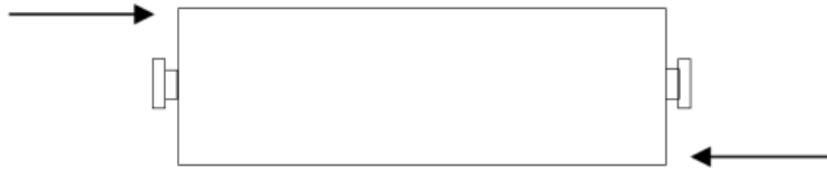
รูปที่ 6 รูปแบบแรงอัดตามแนวยาวทะแยงมุม (ในกรณีที่รถติดตั้ง side buffer) ที่กระทำต่อโครงสร้างรถไฟตามมาตรฐาน EN 12663
