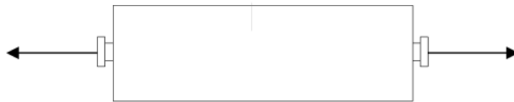
รูปที่ 7 รูปแบบแรงดึงตามแนวยาวที่กระทำต่อโครงสร้างรถไฟตามมาตรฐาน EN 12663
