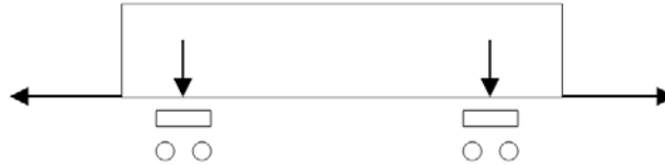
รูปที่ 11 รูปแบบแรงแนวตั้งและแรงดิ่งที่กระทำต่อโครงสร้างรถไฟตามมาตรฐาน EN 12663
