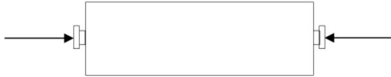
รูปที่ 5 รูปแบบแรงอัดตามแนวยาวที่กระทำต่อโครงสร้างรถไฟตามมาตรฐาน EN 12663
