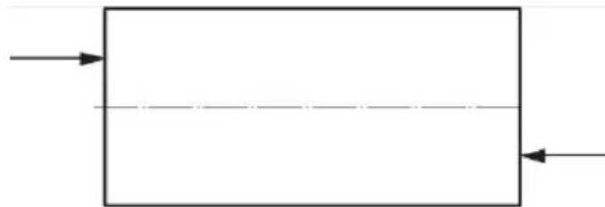
รูปที่ 3 แสดงแรงกดที่กระทำรถขนส่งทางรางด้วย Diagonal Buffers
