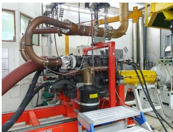
รูปที่ 24 การทดสอบเครื่องยนต์สำหรับเครื่องยนต์รุ่นเก่าของ SBB
