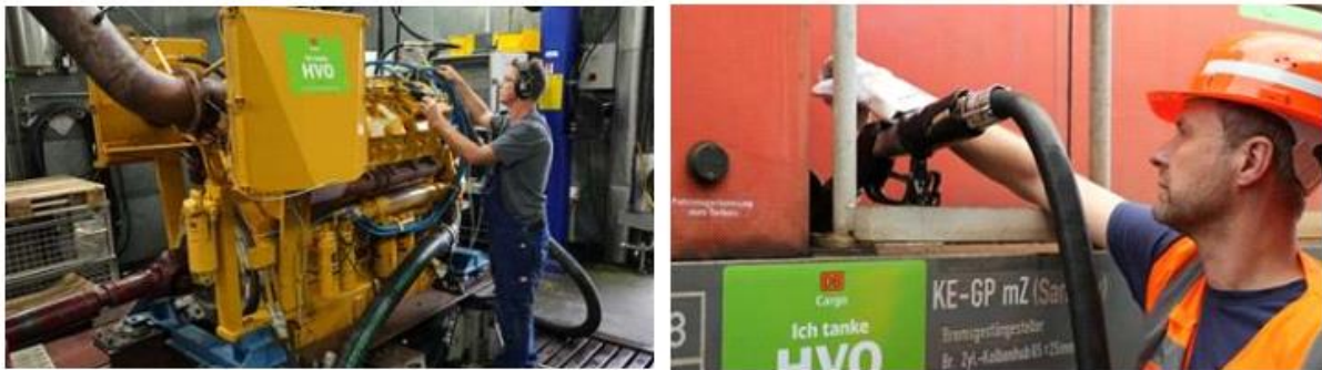
รูปที่ 21 การทดสอบสมรรถนะเครื่องยนต์ที่ใช้ HVO ของ DB Cargo
