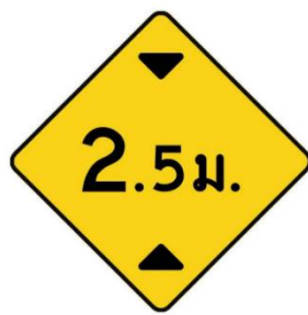
รูปที่ 7 – 3 ตัวอย่างป้ายเตือนทางลอด 2.5 เมตร (ที่มา กรมทางหลวงชนบท)
