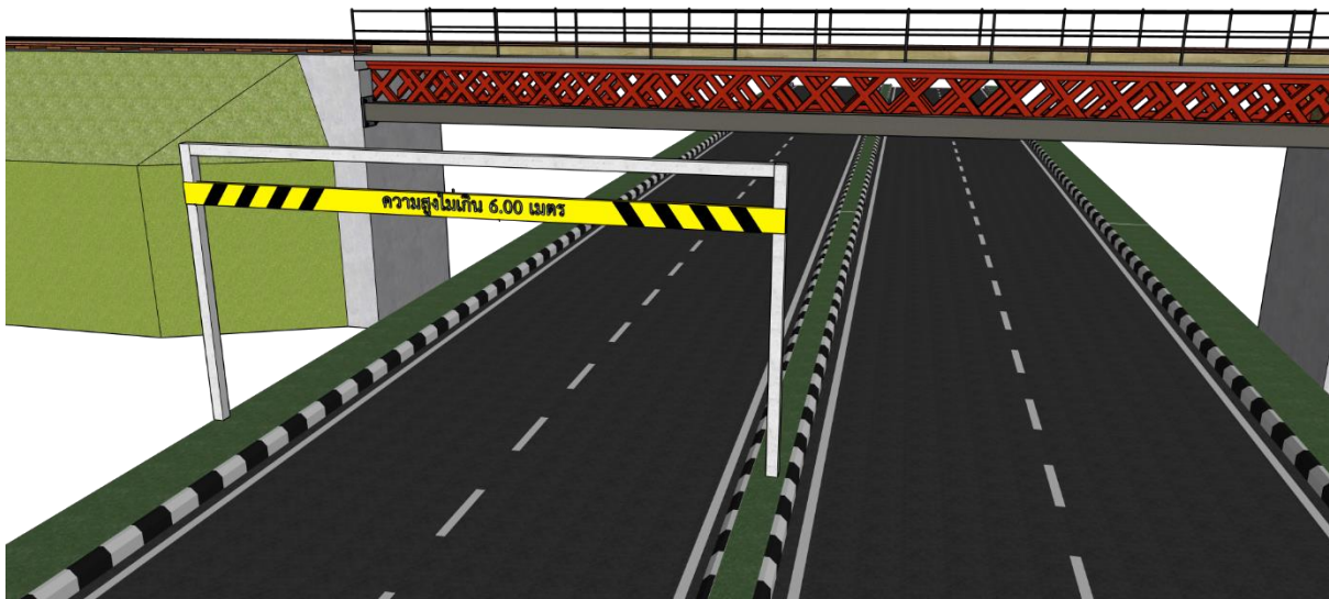
รูปที่ 6 - 6 ตัวอย่างการติดตั้งโครงสร้างเบาที่บริเวณด้านหน้าของโครงสร้างสะพานรถไฟ
